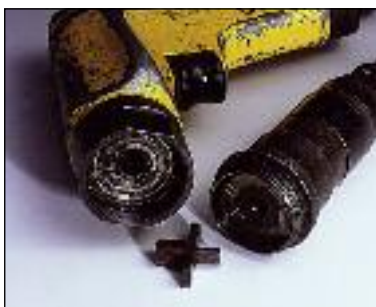
Beschädigte pneumatische Bauteile
